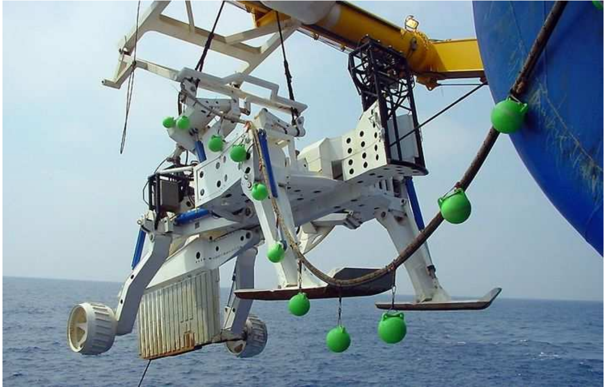
Annexe 3 : Mise à l'eau d'une Charrue sous-marine
