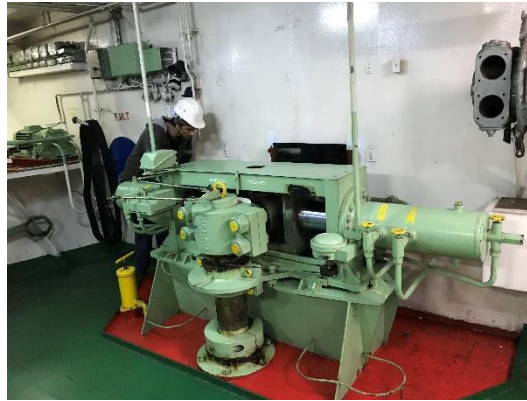
Système de barre permettant une prise manuelle
