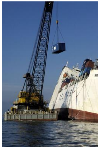
Mesure préventive : enlèvement des conteneurs du porte-conteneurs échoué ROKIA DELMAS (2006).
