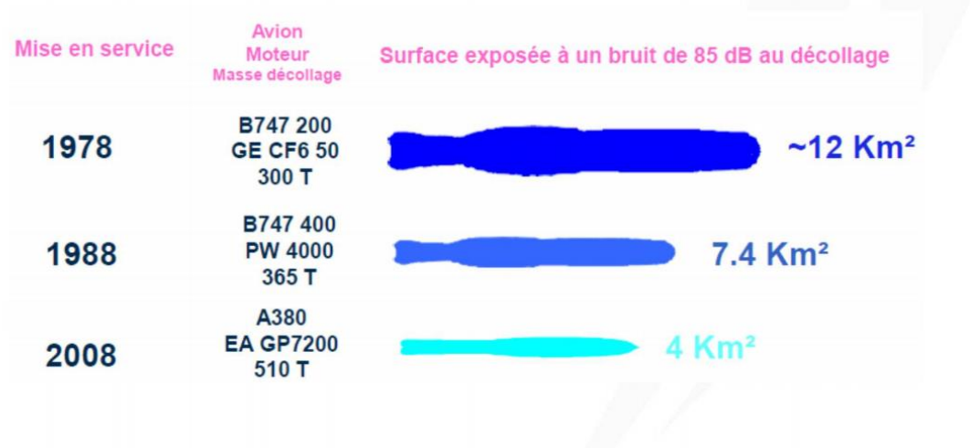
Figure 2 : Schéma représentatif de la réduction du bruit à la source des avions 24
