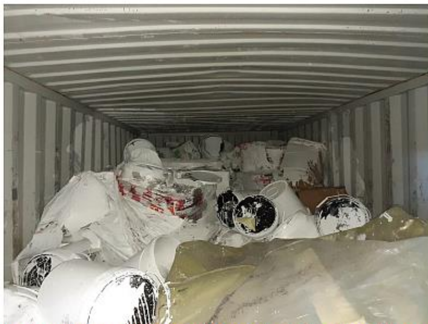
Vue de l'intérieur du conteneur, une bonne partie des pots de peinture s'est ouverte La peinture recouvre les parois et le toit du conteneur = conteneur renversé à 90°
