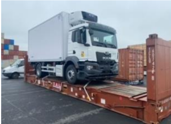
Photo n°1 : Véhicule mis et arrimé sur conteneur Flat – Vue de l'avant du véhicule.
