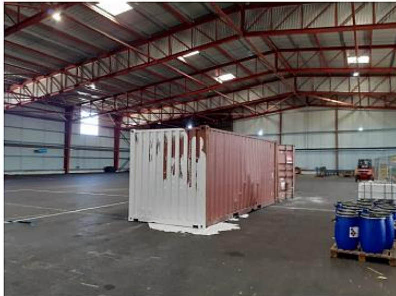
Vue du conteneur dans son ensemble. Le côté gauche est déformé La face avant du conteneur est couverte de peinture blanche
