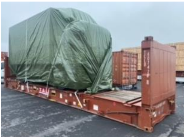
Photo n°3 : Véhicule arrimé et bâché sur conteneur Flat – Vue de l'avant du véhicule.
