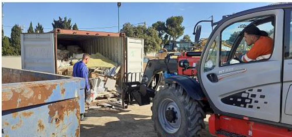
Le dépotage a commencé avec un engin Manitou muni de fourches pour commencer à dépoter l'arrière du conteneur
