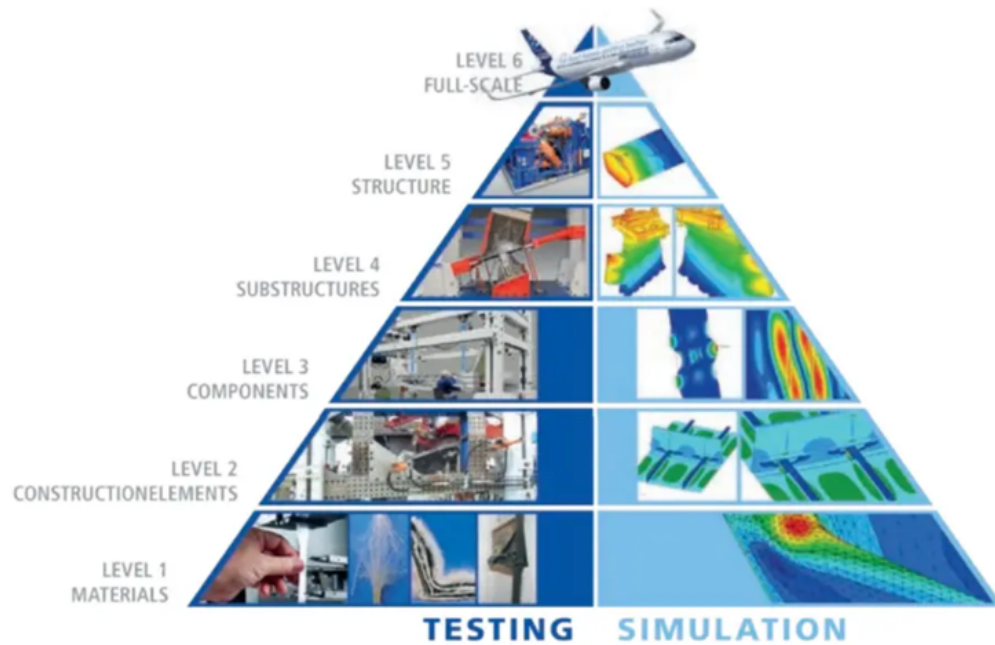
Figure 13 : Chaîne d'étapes nécessaires à la certification d'un aéronaf
